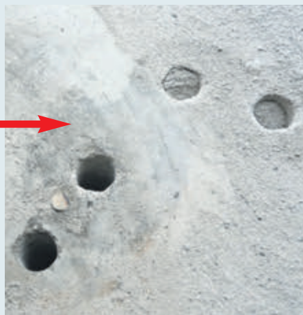
Med det nye bor, hvor støvet suges direkte op gennem boret, er der intet støv bag efter. Hverken i, ved siden af eller nede i hullet. Genialt vurderer testholdet. Absolut testvinder.
