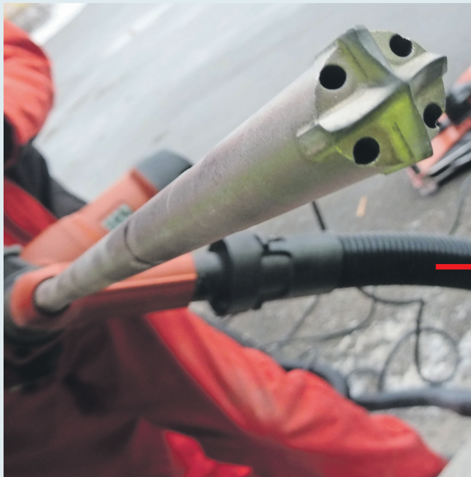
Det nye bor, hvor støvet suges direkte op gennem boret.
