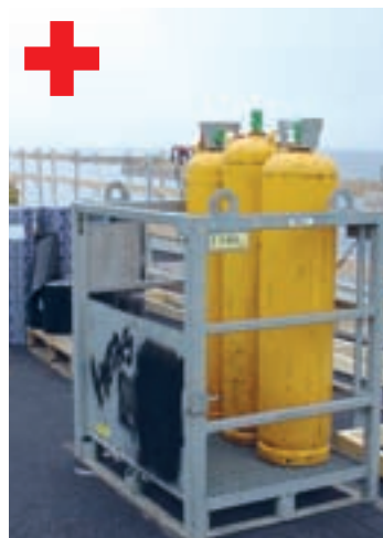
Rigtigt opstillede gasflasker
