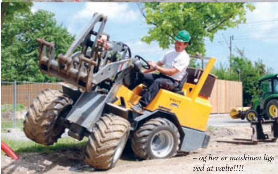
Her kan det tydeligt ses, at selv uden byrde på gafflerne hæver det ene forhjul sig, når maskinen drejer.
